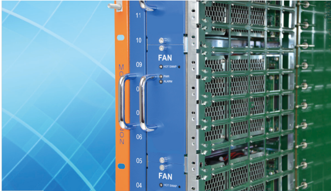
Detailansicht auf einen der drei innovativen und Hot-Swap fähigen Lüftereinschübe
